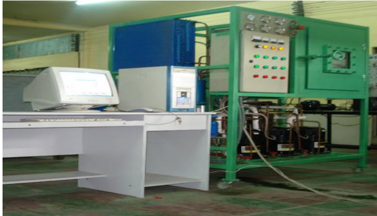
Hình 2. Hệ thống sấy thăng hoa DS-3 tự lạnh đông (-50 \pm -45)^{\circ}\text{C}
