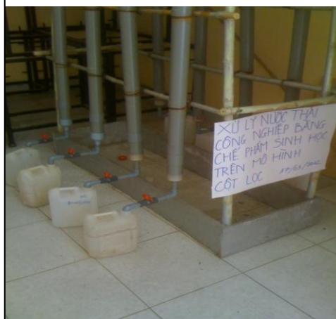
Hình 1. Mô hình cột lọc phác họa và mô hình sử dụng trong nghiên cứu
