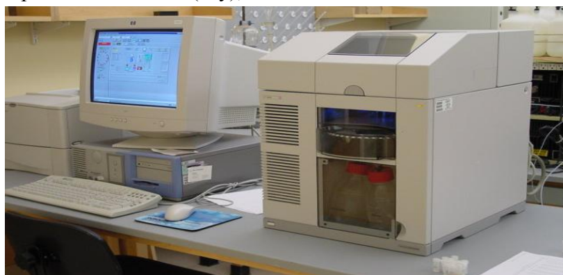
Hình 1. Hệ thống phân tích CE: Máy điện di Agilent
