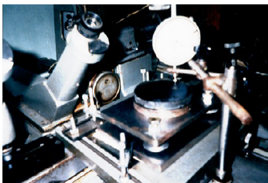
Hình 4. Kết cấu đồ gá và trang bị đo sai lệch về độ thẳng trong mặt phẳng mẫu trên máy đo УИМ-21
