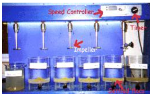
Hình 7. Mô hình thí nghiệm Jartest
