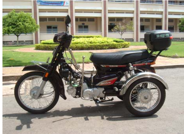
Hình 3.6. Xe ba bánh 3 x 2 sau cải tạo
