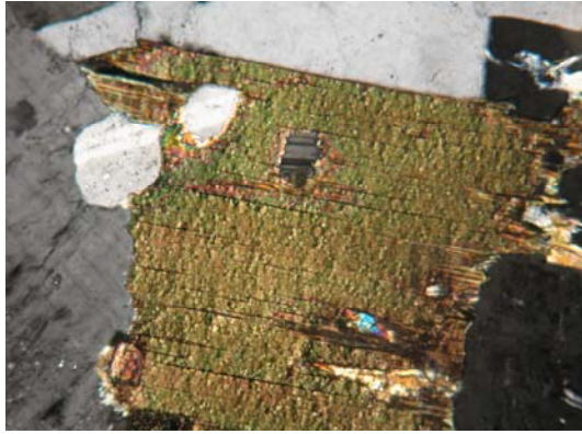
Hình 7: Biotit phát triển và găm mòn plagioclas. Plagioclas tàn dư trong biotit. Zircon trong biotit. (Lm LH12, granit biotit, 2 + , x10)
