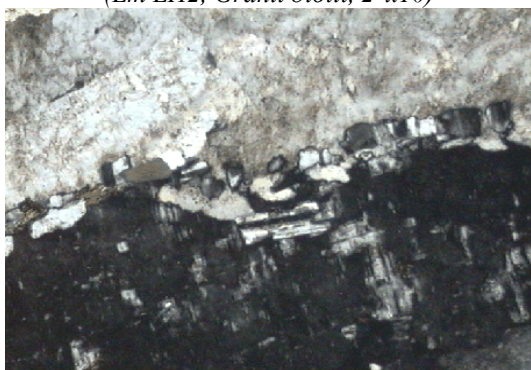
Hình 3: Giữa hai khoáng orthoclas I phát triển các plagioclase II (albit), khoáng orthoclas (phía dưới) albit mọc xen. ( Lm LH1, granit biotit, 2 + , x5 )
