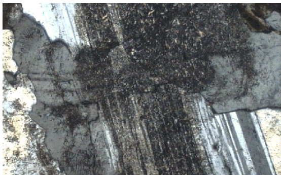
Hình 1: Plagioclase I cấu tạo đa hợp tinh (bị sericit hóa) bị feldpat kali găm mòn ven rìa. ( Lm LH2, Granit biotit, 2 + x10 )
