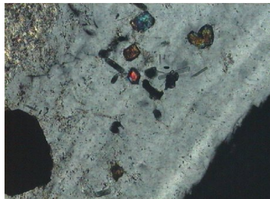
Hình 10: Zircon, apatit dạng bao thể trong orthoclas. (Lm LH6, granit biotit, 2 + , x10)
