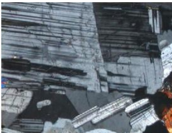
Ảnh 6. Lm HD1. Đá monzogabrodiorit, plagioclas thể hệ I có kích thước lớn chiếm phần lớn ảnh chụp, các tiết diện plag nhỏ hơn phân bố ven rìa pla ( 2Ni^+ ; 3,3x4^x )
