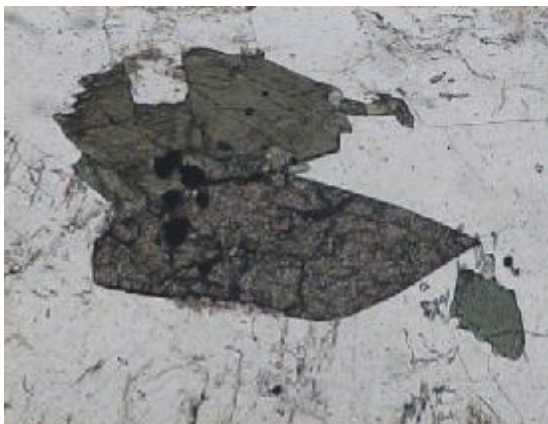
Ảnh 16. Lm HM5A. Đá monzogranodiorit, Tiết diện 2 phương cắt khai của hornblend lục tiết diện sphen hình thoi rất tự hình (1Ni - ; 3,3x4 x )
