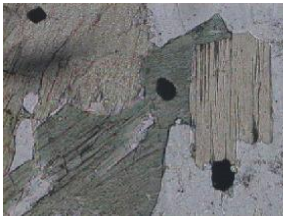
Ảnh 15. Lm HM5A. Đá monzogranodiorit, hornblen bị biotit thay thế (1Ni - ; 3,3x4 x )
