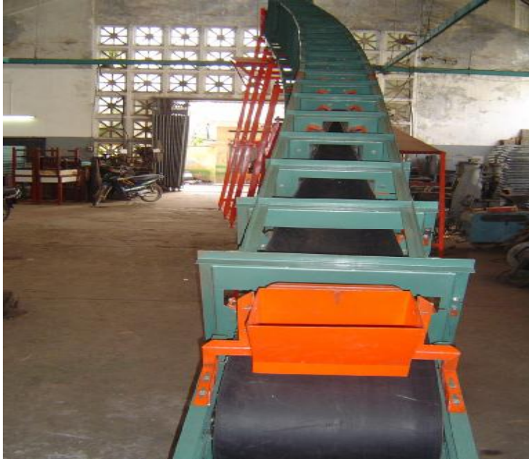
Hình 2.5: Mô hình băng tải ống
