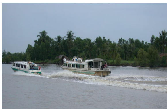
Hình 11. Tàu thuyền tạo sóng gây xói lở bờ (Ảnh: Trần bá Hoàng 2016).
