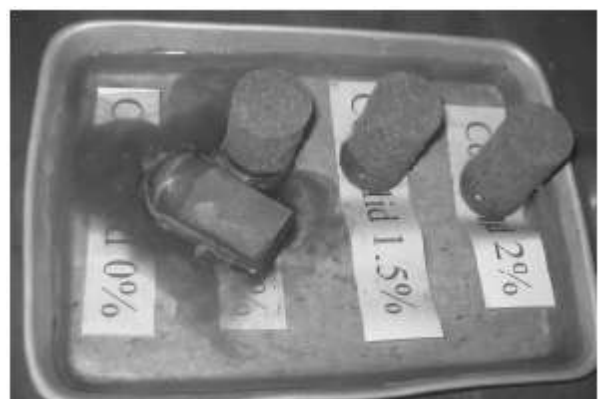
Hình 4: Sau 5 phút mẫu 0% bị sập do rã chân, mẫu 1% có hiện tượng thẩm thấu lên nhanh hơn hai mẫu còn lại
