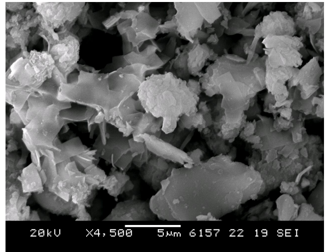
Hình 2: Ảnh chụp cấu trúc bê tông được xử lý hợp chất chống thấm
