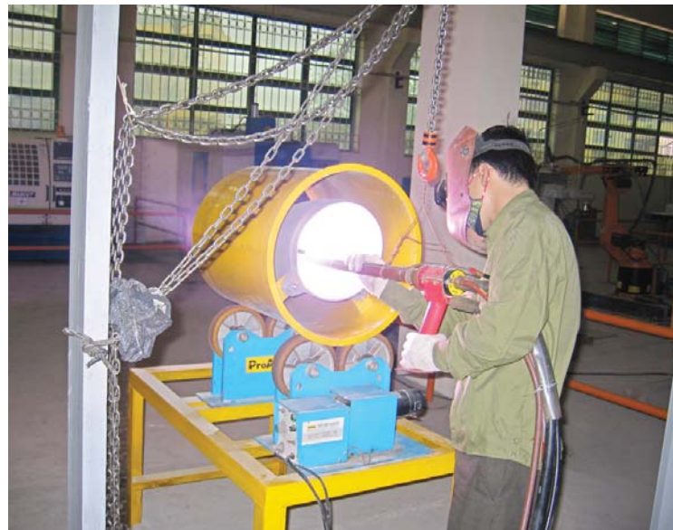
Phục hồi chi tiết máy bằng phun nổ
